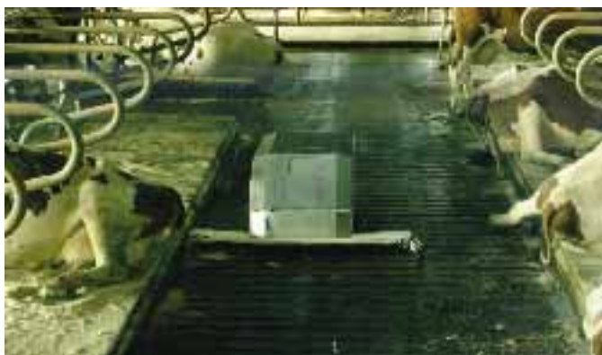
Foto 5.5. Raspador tipo robot a control remoto.
