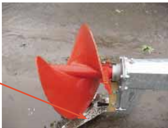
Foto 5.8. Mezclador de sinfín con picador incorporado.
