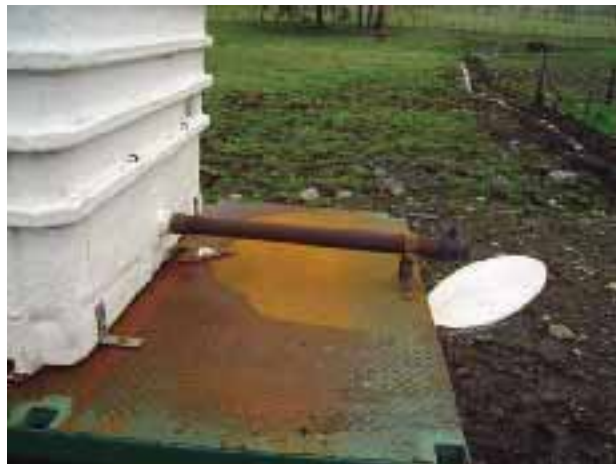
Foto 5.17. Carro simple con vaciado gravitacional.
