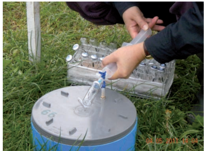
Foto 1. Cámaras estáticas empleadas para la determinación de las emisiones de GEI en praderas a) cámara abierta, b) cámara cerrada durante el muestreo.
