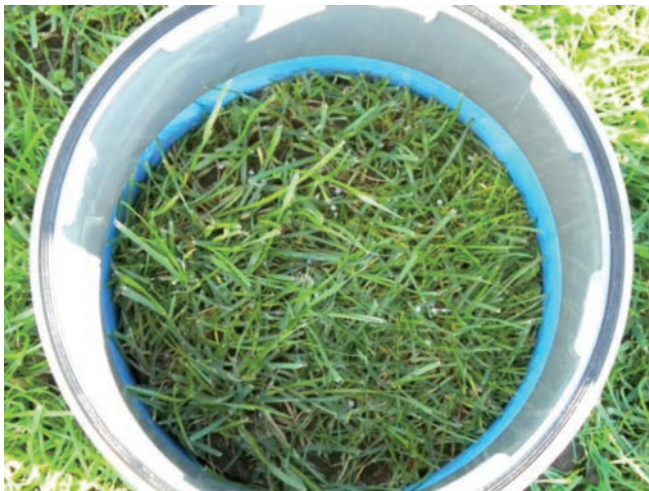
Foto 1. Cámaras estáticas empleadas para la determinación de las emisiones de GEI en praderas a) cámara abierta, b) cámara cerrada durante el muestreo.
