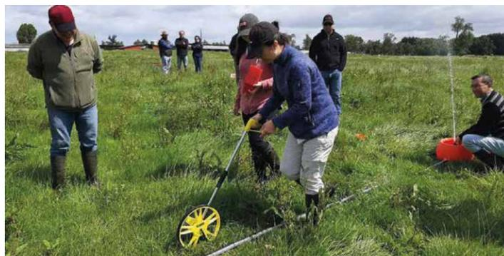
■ Imagen B. Medición del punto medio entre los últimos 2 aspersores para posicionar la 2ª línea de colectores.
