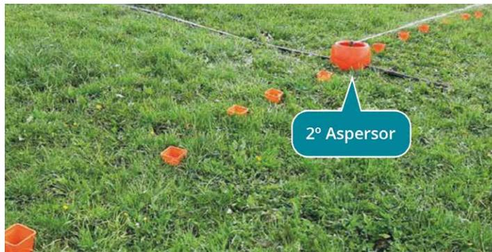
■ Imagen A. Ejemplo del posicionamiento de los colectores en el 2º aspersor.
