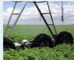
Las unidades de accionamiento y la estructura de soporte también se conocen como torres y controlan el movimiento de la máquina. Cada unidad de transmisión consta de un motor de transmisión, cajas de engranajes, ruedas y una caja de control eléctrico conocida como caja de torre.
