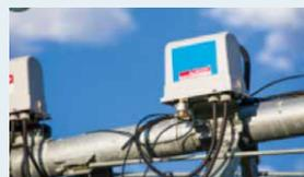
Cada torre tiene una caja eléctrica que utiliza varios componentes para controlar el movimiento y la alineación del pivote.
