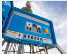
El panel de control es el cerebro de la operación. Permite al operador controlar toda la máquina enviando comandos a las cajas de torre montadas en cada unidad de transmisión. El panel de control controla los movimientos de parada, arranque, avance y retroceso del pivote, uso de agua y mucho más.
