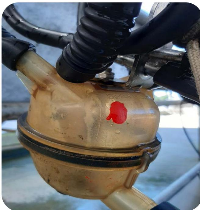
Figura 12. Colectores con residuos por fallas en lavado por turbulencia (derecha).
