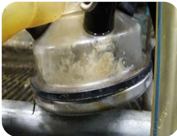
Figura 11. Colectores con residuos por fallas en lavado por temperatura de agua.
