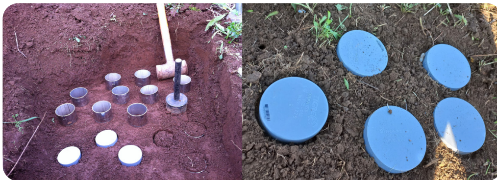
Figura 7. Fotografías de colecta de suelo no disturbado con cilindros metálicos, para la evaluación de densidad aparente y distribución de poros (Fotografías S. Valle).
